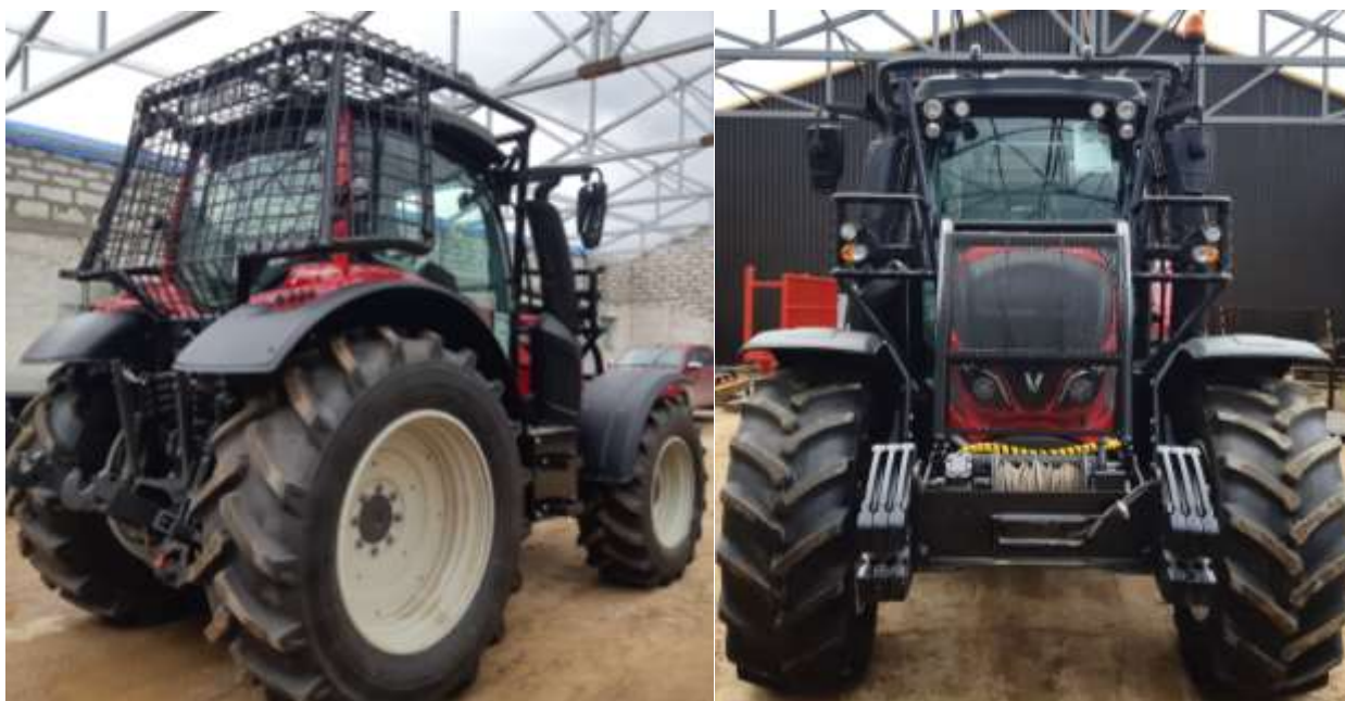
Aprīkots lauksaimniecības riteņtraktors mežsaimniecības darbiem
